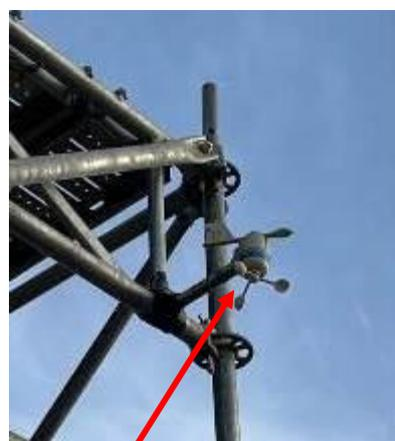
Nous avons mis en place une centrale météo à la régie World Stage pour mesurer en permanence la vitesse du vent et sa direction, la température de l'air et son hydrométrie.
