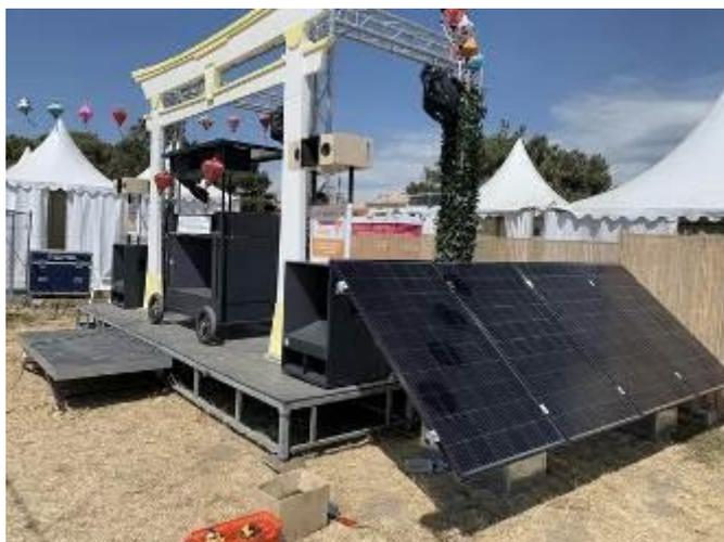
**Pour la scène Tiki Stage,** Nous avons mesuré au sonomètre de classe 1 que le niveau serait calé sur 96 dB(A). Nous avons fait modifier le système sonore pour que les subs fonctionnent en cardioïdes.
